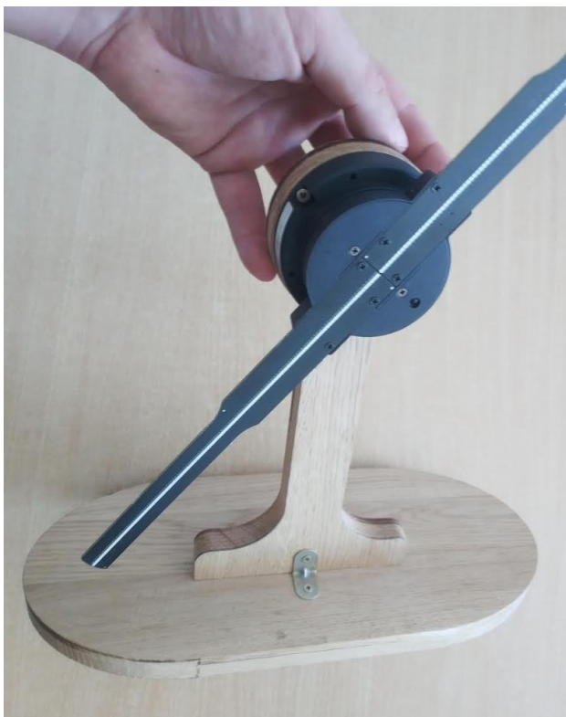
Рисунок 3.4 – Програмно-апаратний пристрій для голографічної проекції
