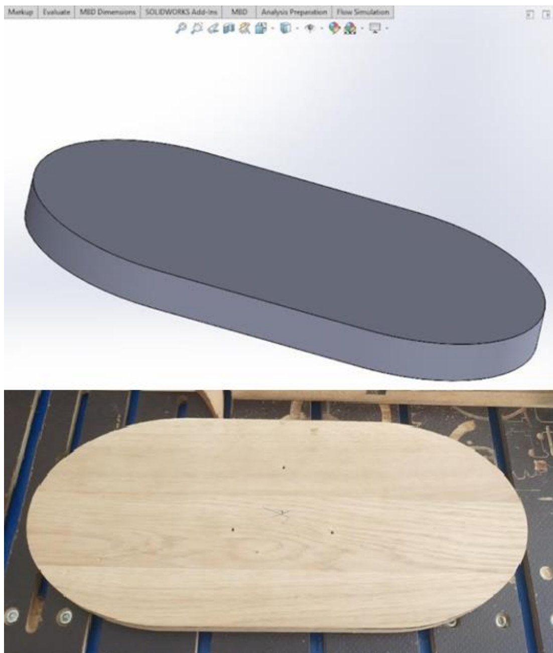
Рисунок 3.2 – 3D-модель елемента основи корпусу та готовий виріб
