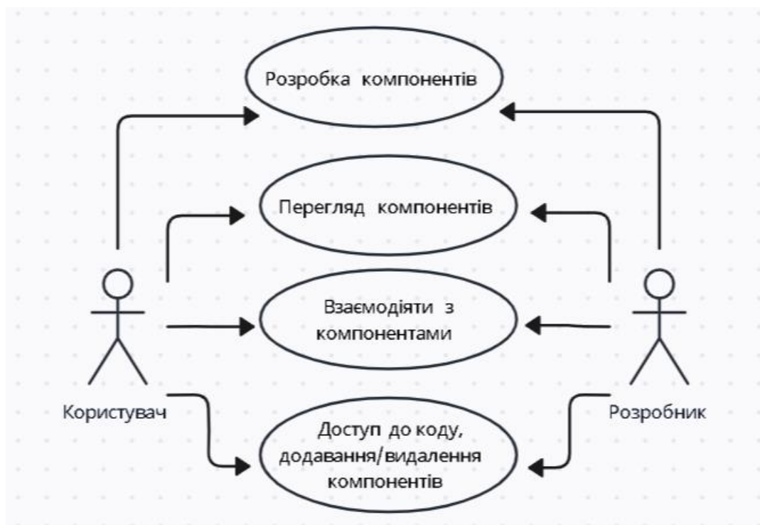
Рисунок 2.1 – Діаграма варіантів використання компонентів бібліотеки
