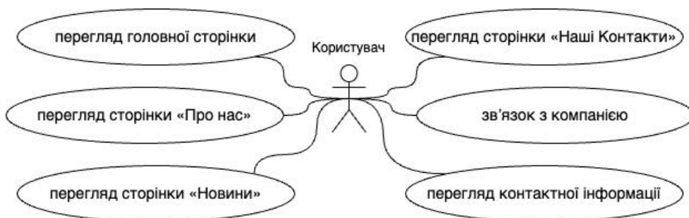
Рисунок 2.1 – Діаграма використання для актора «Клієнт»
