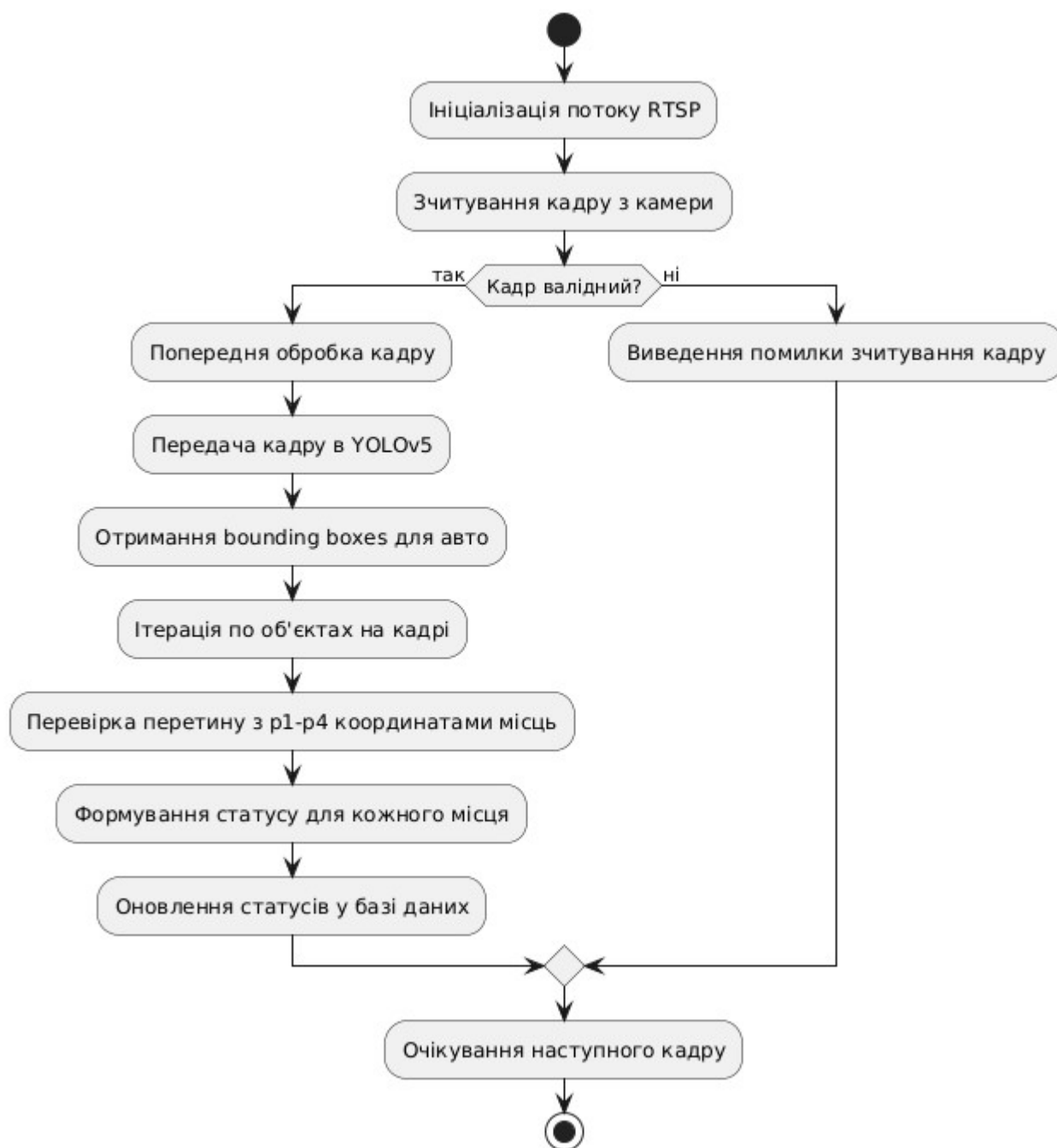
Рисунок 2.1 – Архітектурна схема системи моніторингу паркомісць
