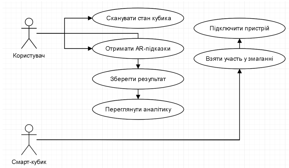
Рисунок 2.1 – UML-діаграма варіантів використання для системи аналізу та складання кубика Рубіка
