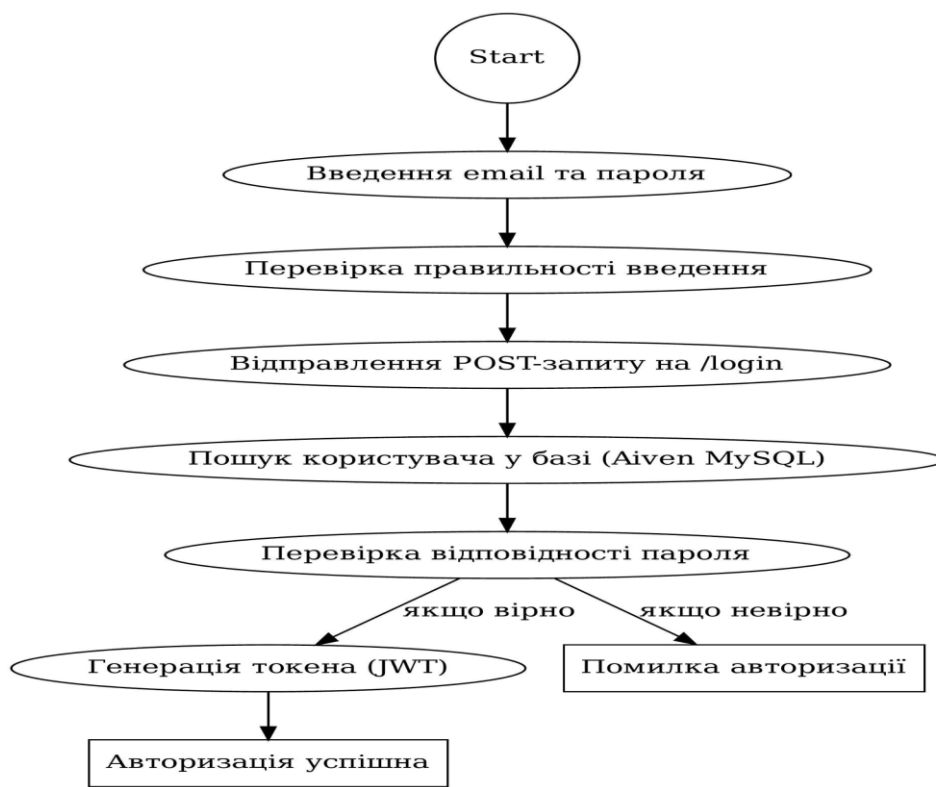
Рисунок 2.2 – Блок-схема алгоритму авторизації
