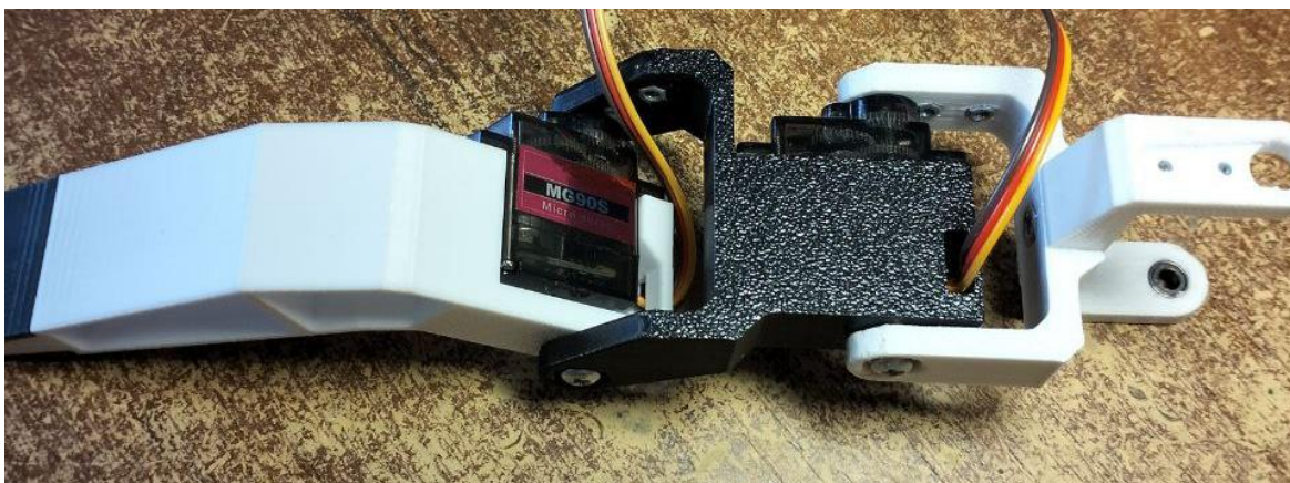
Рисунок 3.2 – Зібрана нога багатоногого робота з трьома сервомеханізмами
