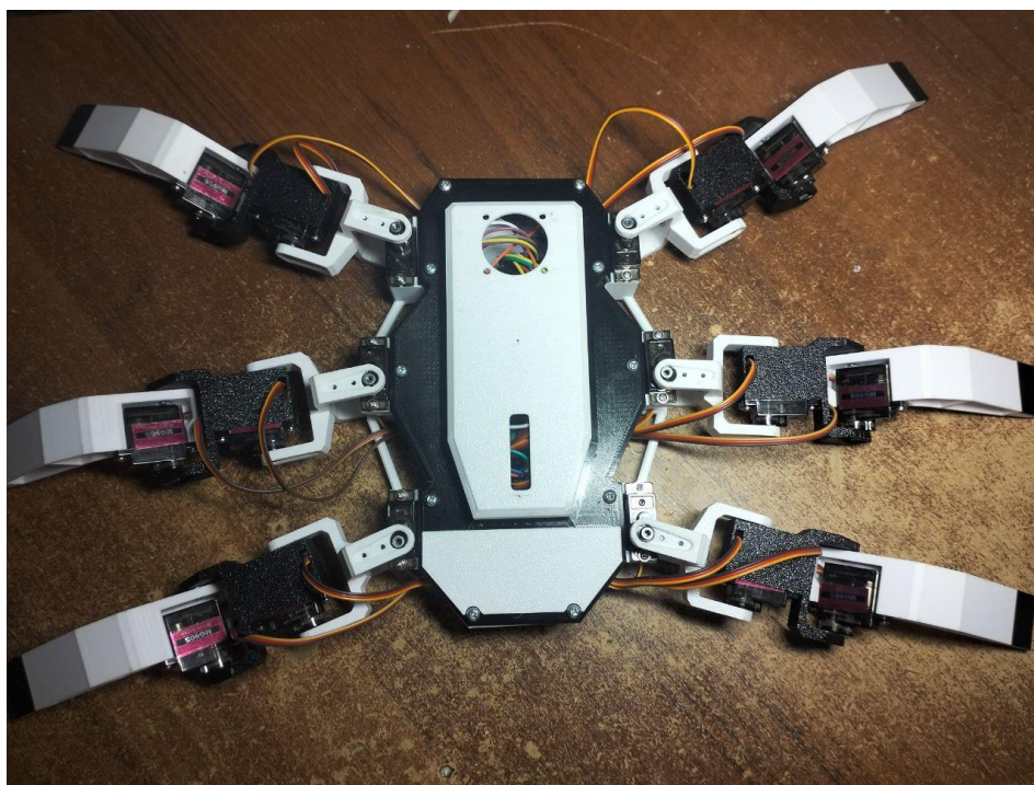
Рисунок 3.5 – Повністю зібраний багатонорий робот
