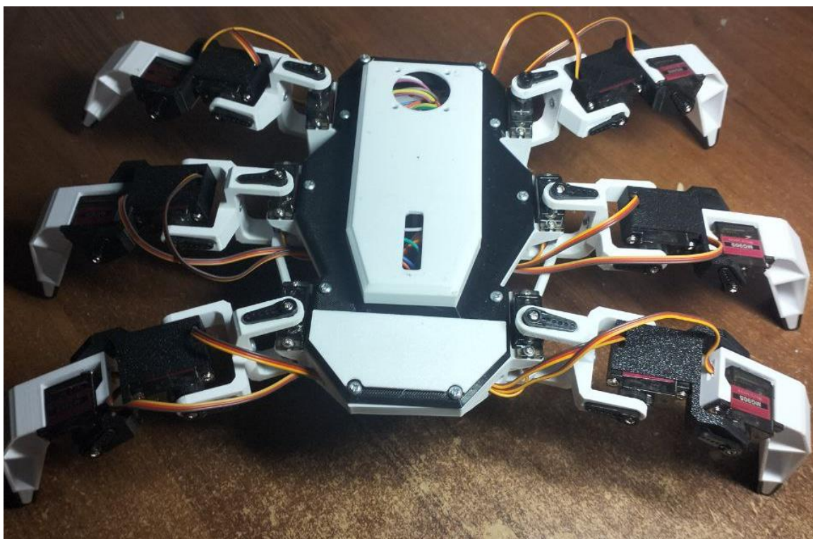
Рисунок 3.8 – Узгоджений рух усіх ніг у циклічному режимі ходьби
