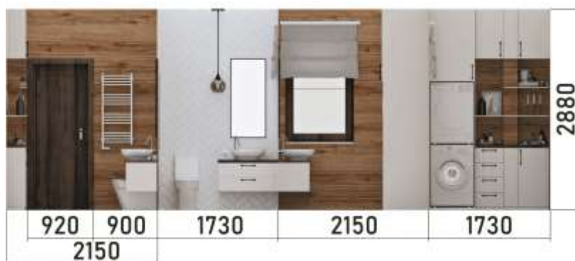
Рис. В.8. Розгортка стін санвузла
